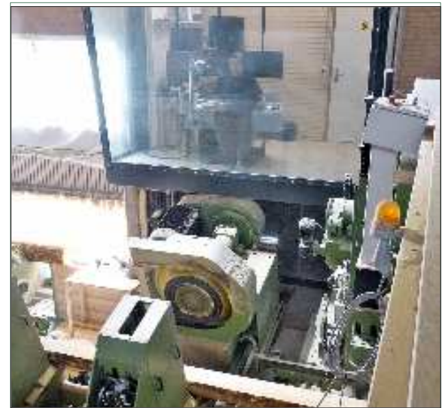
Der seitlich angebracht, Spanerantrieb gibt dem Sägenführer eine optimale Sicht auf die Stammoberfläche.
