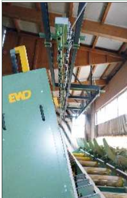
Stammvermessung bei der Aufgabe auf den Blockbandsägewagen über einen oben aufgehängten Messbalken
